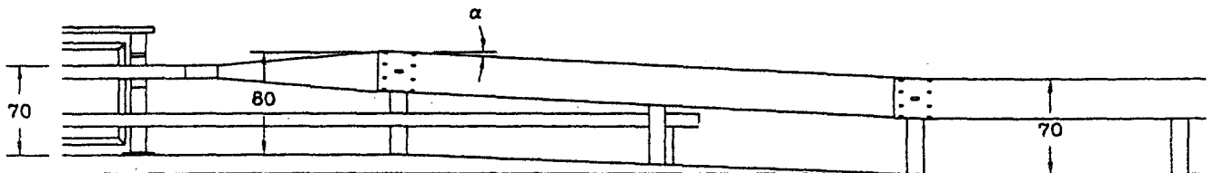
Largeur trottoir = 1m, hauteur bordure = 15cm
